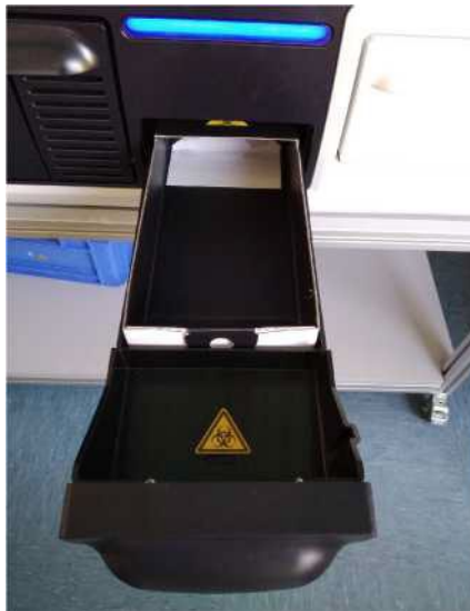
Малюнок 5-49: Контейнер для твердих відходів з контейнером EASY у приладі
