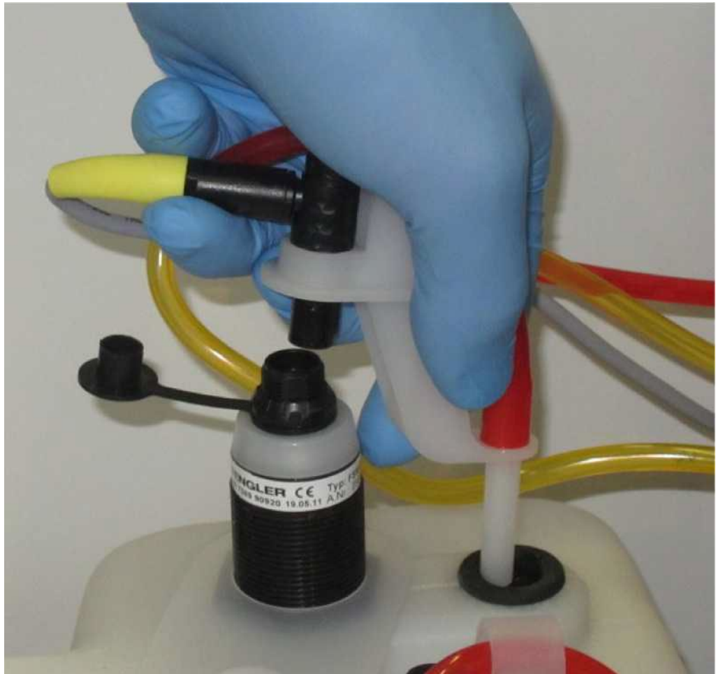
Малюнок 5-32: Під час від'єднання роз'єму трубка також витягується з мембрани
