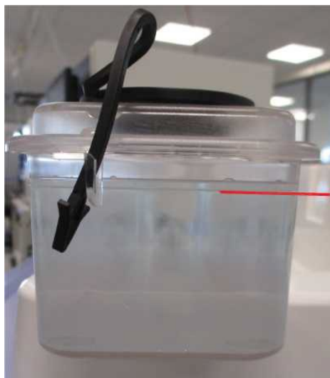
Малюнок 5-27: Резервуар промивного буфера - мітка заповнення 2,7 літрів, нижній край позначений червоним кольором
