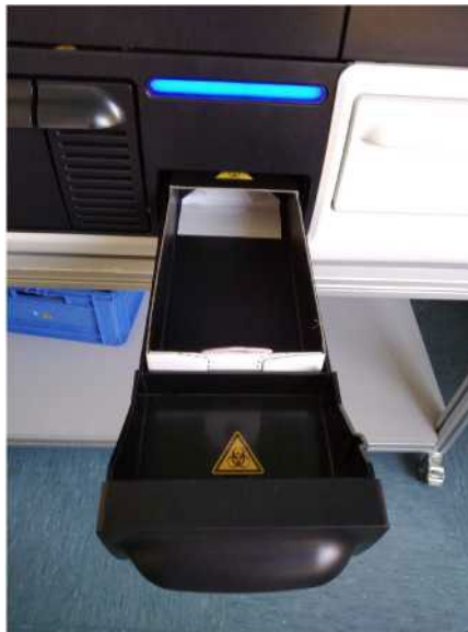
Малюнок 5-50: Отвір для коробки з контейнера для твердих відходів
