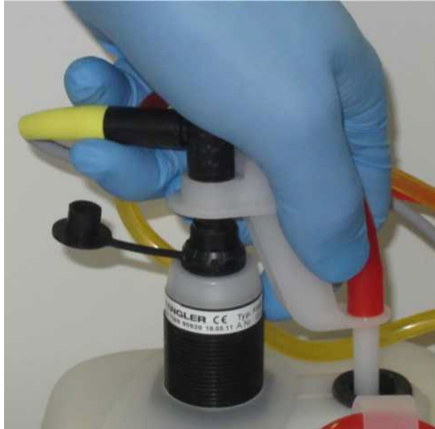
Малюнок 5-33: Під час введення трубки в мембрану роз'єм також підключається до датчика
