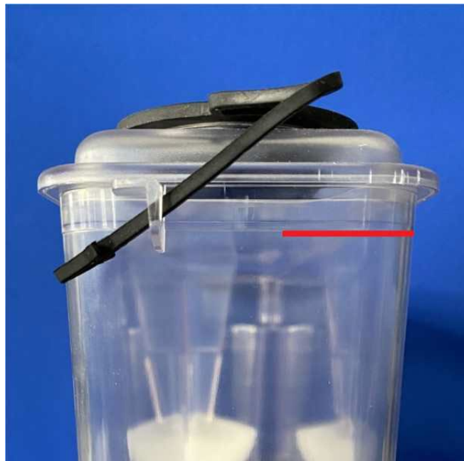
Малюнок 5-22: Резервуар для системної рідини - лінія заповнення 5 літрів, нижній край позначений червоним кольором
