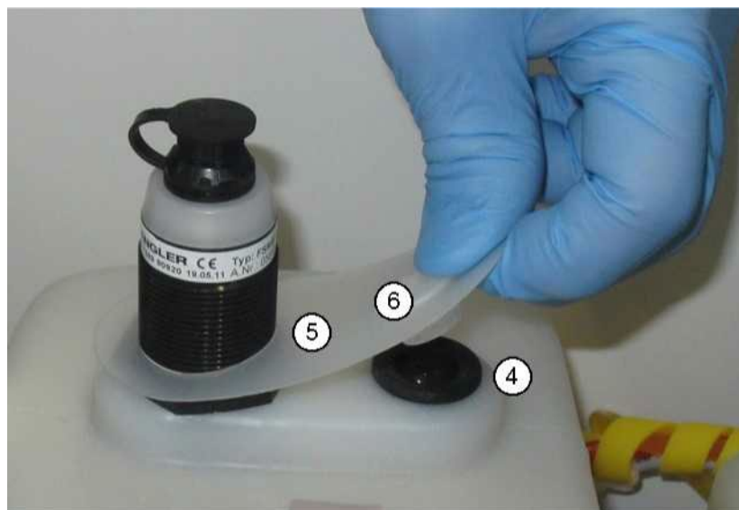
Малюнок 5-35: Обертання гумової смужки та закриття мембрани кришкою
