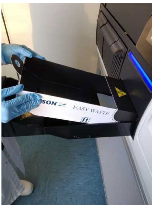
Малюнок 5-52: Напрямок стрілки на коробці для відходів EASY
