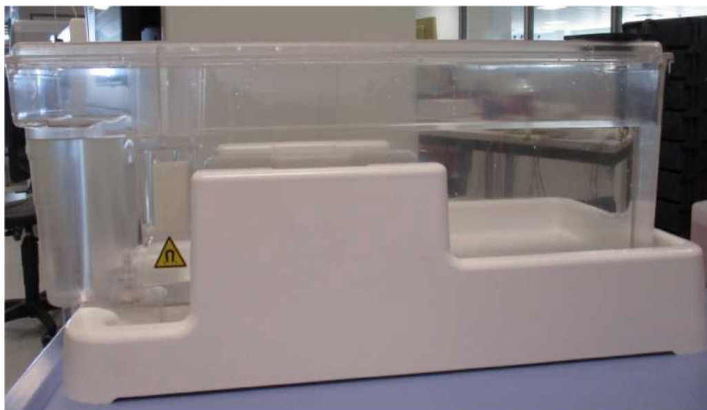
Малюнок 5-23: Підготовка системної рідини - правильне встановлення резервуару для системної рідини
